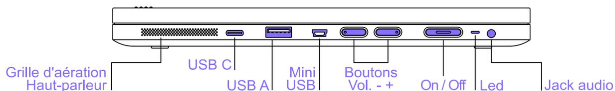
De bas en haut se trouvent une grille pour le haut-parleur et l'aération, puis un port USB C pour connecter un périphérique USB C, un port USB 3, un port mini-USB, puis le bouton volume -, pour diminuer le volume, puis le bouton volume +, pour augmenter le volume,, un indicateur LED qui est rouge dès que l'appareil est allumé, puis le bouton On Off, et un connecteur jack 3.5mm pour brancher un casque, ou un micro-casque, ou un haut-parleur additionnel.
