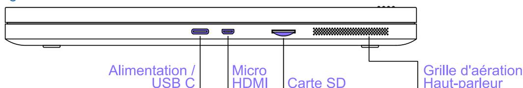
De bas en haut se trouvent une grille pour le haut-parleur et l'aération, puis une fente pour carte micro-SD (pour l'insérer, tenez la carte micro-SD en orientant les contacts vers le bas, et la flèche vers la fente, appuyez délicatement jusqu'au déclic de mise en place), puis un port micro HDMI et un port USB C pour charger la tablette et/ou pour connecter tout périphérique USB-C.
